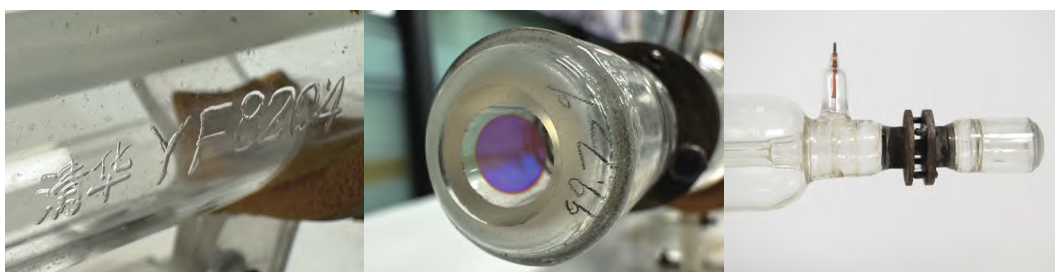
图2 氩氖激光器具体细节（图左为激光器编号，中为半反射镜与手写反射率，右为阳极与可伐）
