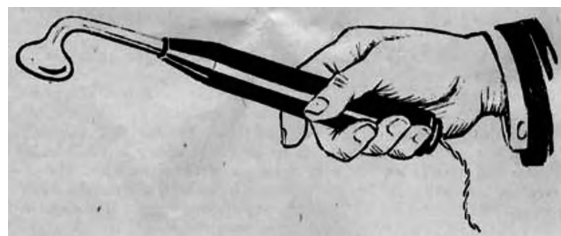
图 3 电极与木柄的安装示意图
