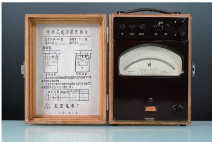
名称：便携式电动系瓦特表 尺寸：28.4cm×21cm×17.6cm 材质：金属、电木、复合材料 年代：1964 年 产地：北京电表厂 来源：清华大学能源与动力工程系捐赠
