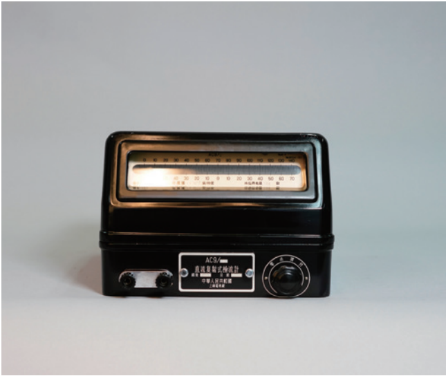
名称：直流复射式检流计 尺寸：32.5cm×22cm×15.5cm 材质：金属、复合材料、电木 年代：1964 年 产地：上海电表厂 来源：清华大学核能与新能源技术研究院捐赠
