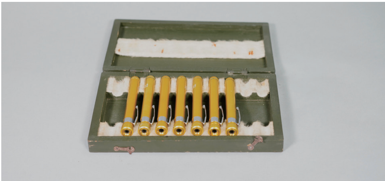
名称：L6002 型 5-1 剂量笔 尺寸：长 11.3cm 半径 0.75cm 材质：金属、复合材料 年代：1960 年 产地：北京综合仪器厂 来源：清华大学核能与新能源技术研究院捐赠
