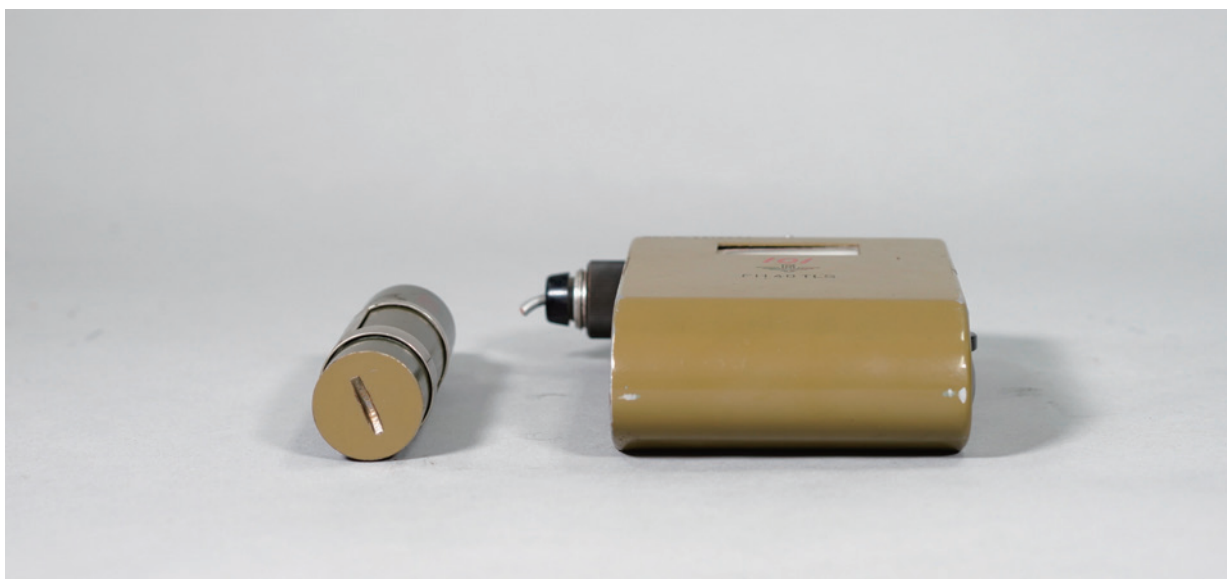
名称：FH 40 TLS 型辐射计 尺寸：16.2cm×10cm×4.5cm 材质：金属 年代：20 世纪 50-60 年代 产地：民主德国，Frieeseke&Höpfner 来源：清华大学核能与新能源技术研究院捐赠
