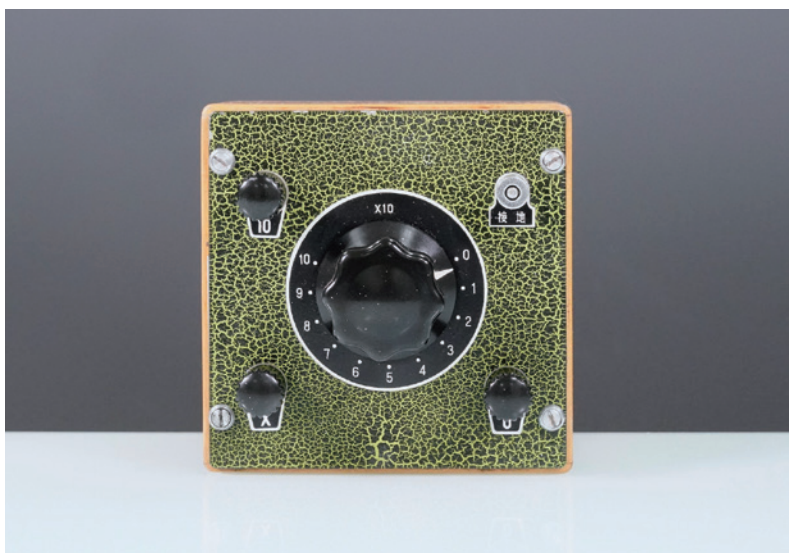
名称：高周波单电阻箱 尺寸：13cm×13cm×17cm 材质：金属、电木、复合材料 年代：1958 年 产地：上海沪光科学仪器厂 来源：清华大学能源与动力工程系捐赠
