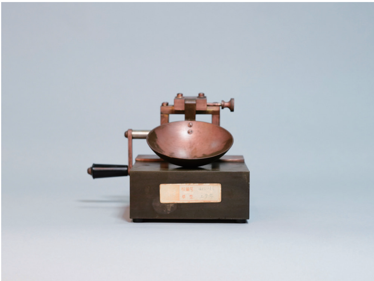
名称：碟式液限仪 尺寸：18cm×15cm×15cm 材质：金属、电木、复合材料 年代：1947 年前 产地：美国 来源：清华大学水利水电工程系捐赠
