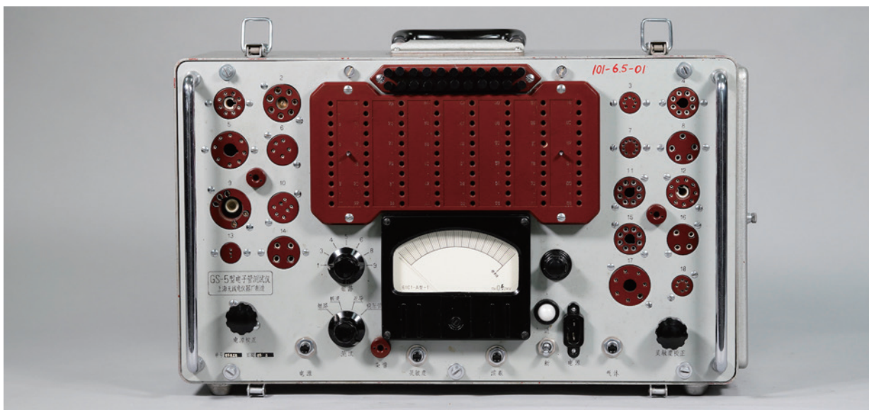
名称：GS-5 型电子管测试仪 尺寸：48cm×22cm×32cm 材质：金属、电木、复合材料 年代：1965 年 产地：上海无线电仪表厂 来源：清华大学核能与新能源技术研究院捐赠
