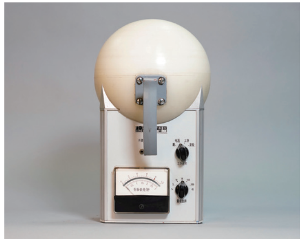
名称：FJ-342 生物中子剂量仪 尺寸：21cm×26cm×37cm 材质：金属、塑料、复合材料 年代：1972 年 产地：北京综合仪器厂 来源：清华大学核能与新能源技术研究院捐赠
