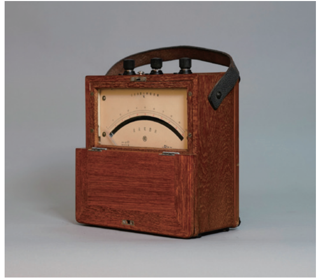
名称：1511 型直流电压表 尺寸：20cm×23cm×10cm 材质：金属、复合材料、木材 年代：1956 年 产地：公私合营大华仪表厂 来源：清华大学核能与新能源技术研究院捐赠
