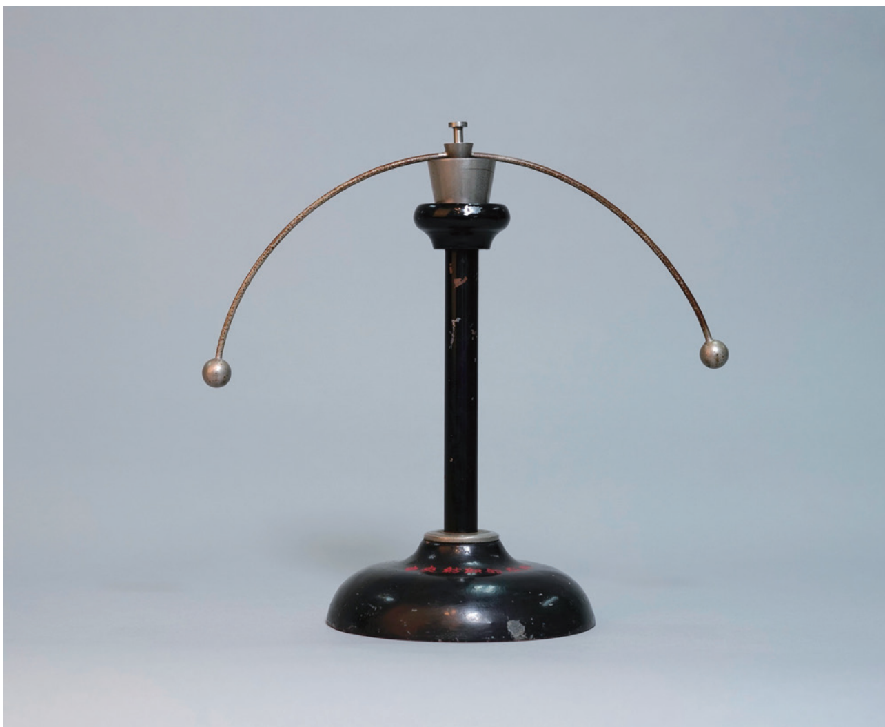
名称：锥式液限仪 尺寸：15cm×15cm×27cm 材质：金属 年代：20 世纪 40-50 年代 产地：中国 来源：清华大学水利水电工程系捐赠
