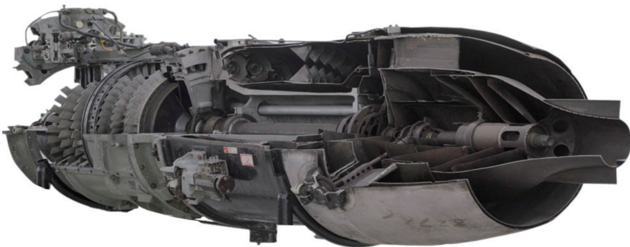
名称：轴流式涡轮喷气发动机 尺寸：330cm×80cm×150cm 材质：金属 年代：20 世纪 40 年代 产地：苏联 来源：清华大学能源与动力工程系提供
