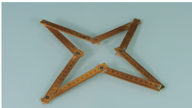
名称：八折尺 尺寸：100cm×1.6cm 材质：木材 年代：20 世纪 50 年代 产地：江西武夷山篁村工艺厂 来源：清华大学建筑学院楼庆西先生捐赠
