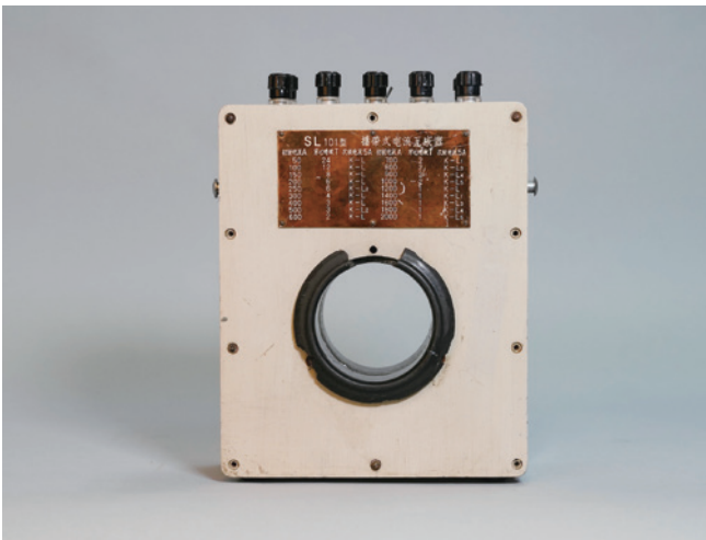
名称：SL101 型携带式交流互感器 尺寸：20cm×9cm×26cm 材质：金属 年代：1960 年 产地：地方国营苏州电线电缆厂 来源：清华大学核能与新能源技术研究院捐赠
