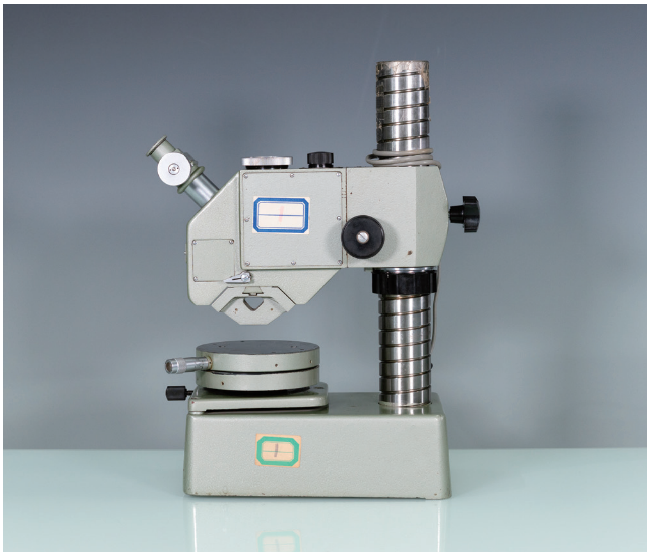
名称：JSG-1 型光切法显微镜 尺寸：31cm×17cm×41cm 材质：金属 年代：1981 年 产地：上海光学仪器厂 来源：清华大学精密仪器系捐赠
