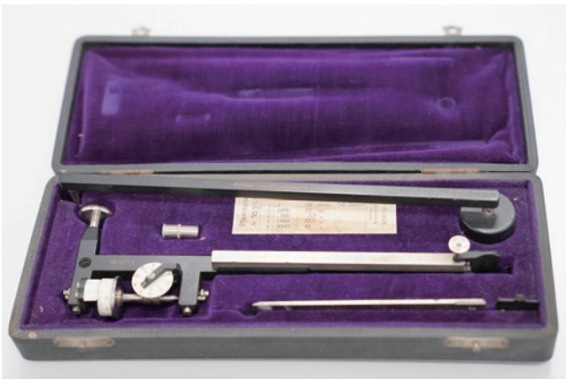
名称：极点机械求积仪 尺寸：24cm×9cm×4cm 材质：金属 年代：1947 年前 产地：德国 R.Reiss G.m.b.H. Liebenwerda 来源：刘仙洲先生家属捐赠
