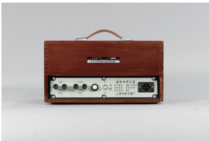
名称：磁饱和稳压器 尺寸：37cm×18cm×20cm 材质：金属、复合材料 年代：1976 年 产地：上海分析仪器厂 来源：清华大学核能与新能源技术研究院捐赠
